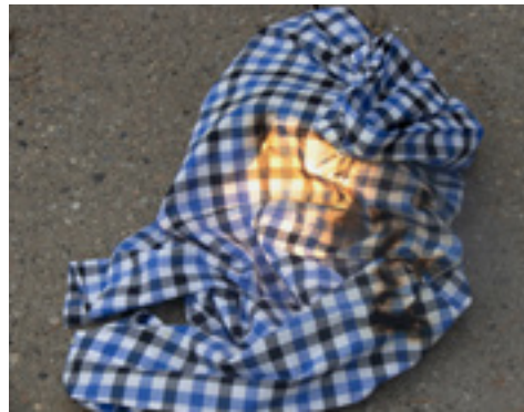
Fører tildekking av halogenlampe til brann?
